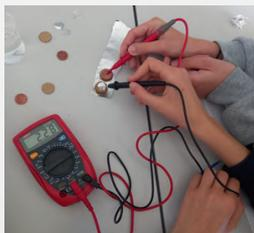
Nel laboratorio di scienze con MYP3 red gli studenti hanno lavorato alla realizzazione della pila di Volta con monete di rame, alluminio e acqua salata, mentre gli MYP3 green hanno realizzato la pila con monete di rame e striscia di alluminio inserite nella frutta e verdura.
